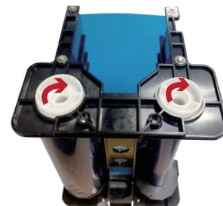
將照箭頭指示處向下壓之後，按照箭頭方向旋轉，將色帶於色帶匣上轉至最緊
