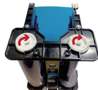
Drücken Sie auf das mit einem Pfeil gekennzeichnete Teil und drehen Sie das Farbband, bis das Farbband so fest wie möglich auf der Patrone sitzt.
