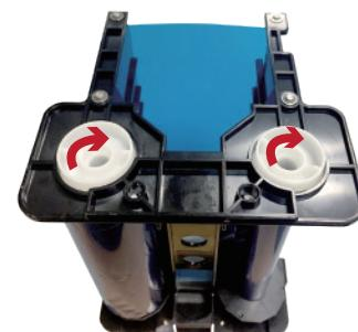
Presione hacia abajo en la parte indicada por una flecha, y desplace la cinta como se indica en la flecha, hasta que la cinta esté lo más ajustada posible en el cartucho.
