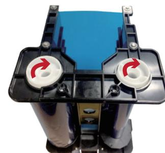
将照箭头指示处向下压之后，按照箭头方向旋转，将色带于色带盒上转至最紧
